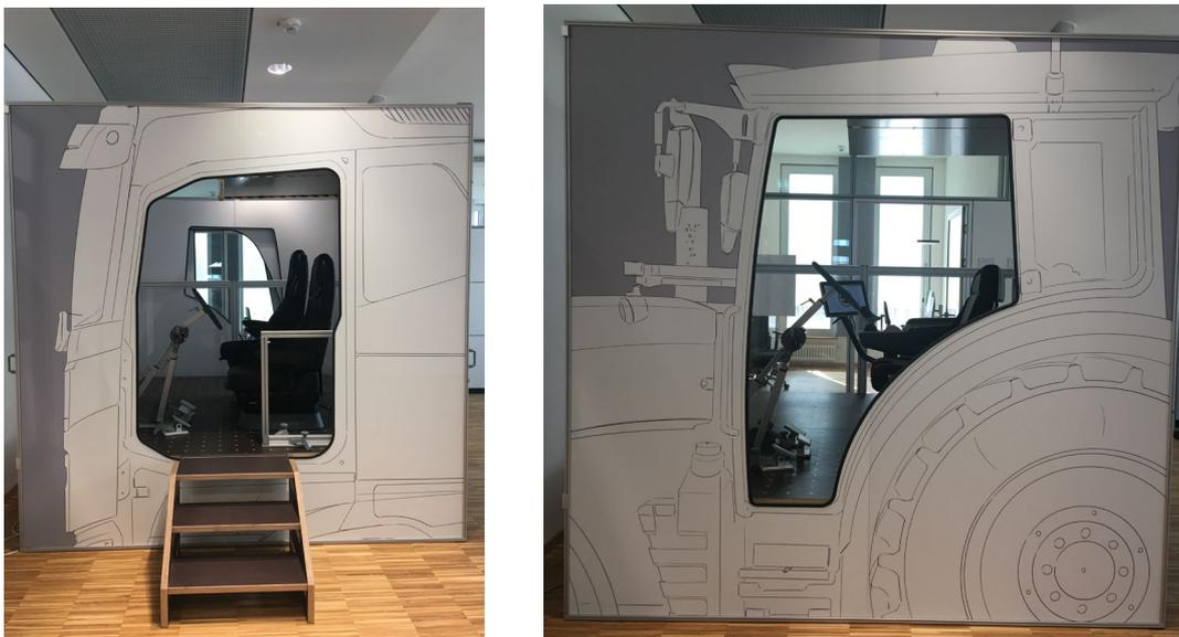
**Abbildung 6:** Variables Nutzfahrzeugmockup im Aufbau LKW und Traktor im Perceived Quality Space am GRAMMER-Campus Ursensollen
