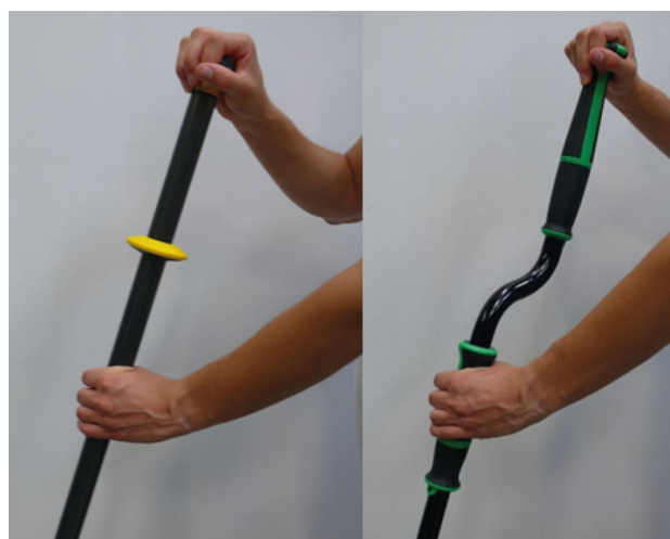
Abbildung 2: Vorgegebene Greifhaltung bei Stielen mit Knauf in Gruppe A
