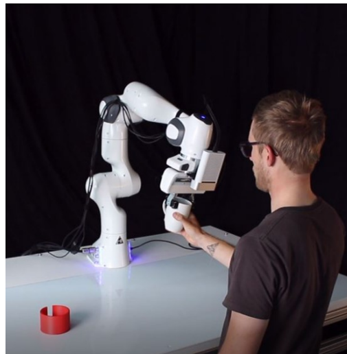
Abbildung 1: Technischer Aufbau des Übergabeexperiments mit Panda Roboterarm und Greifer von Franka Emika.
