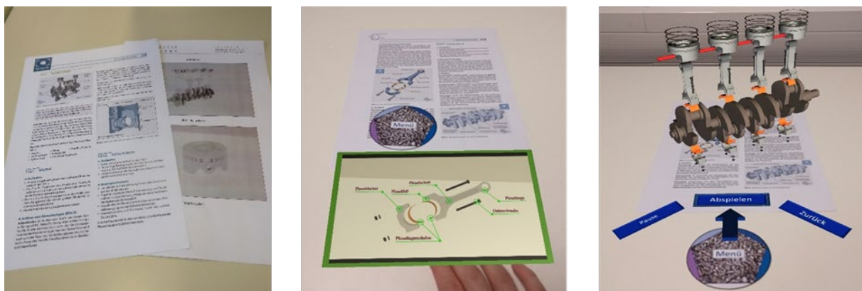
Abbildung 1: Zusatzinformationsart A in Papierform (links), Art B mit Menü-Marker und Auswahl-Marker (befindet sich an Stelle des Videos) und Videos (Mitte), Art C mit einem Marker und 3-D-Modellen und -Animationen. B und C wurden in der 3-D-Entwicklungsumgebung Unity (Version 2019.4.0f1) und dem Vuforia Kit für markerbasiertes AR erstellt.
