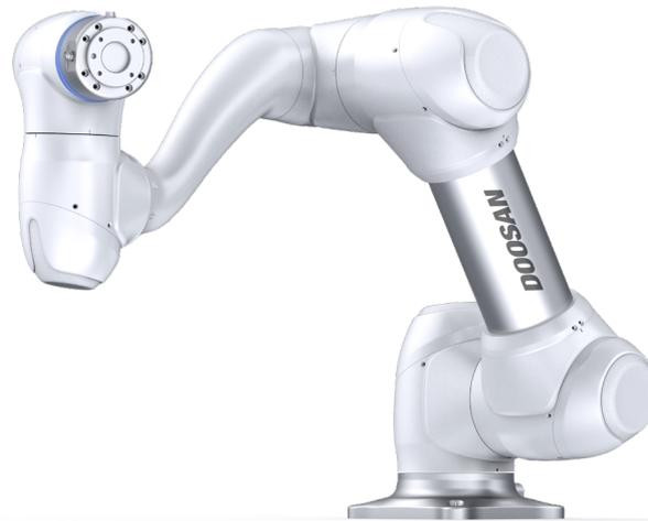
**Abbildung 1:** 6-Achs-MRK-Roboter des Herstellers Doosan Robotics, M-Series, Typ M0609
