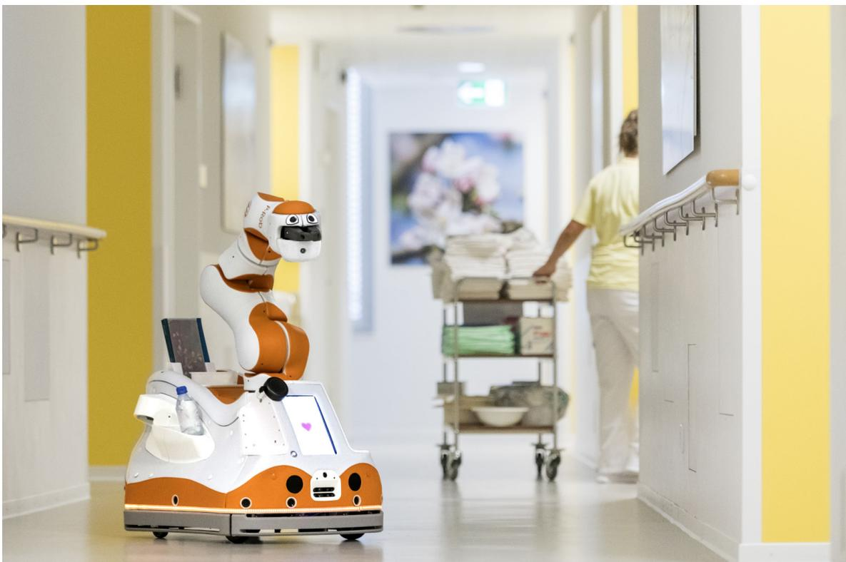
**Abbildung 2:** *Mobiler Serviceroboter Lio in einer Anwendung in der Pflegeassistenz (Bildquelle: F&P Robotics, Glattbrugg, CH).*
